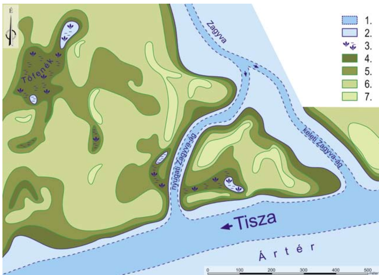
3. ábra. Szolnok városmagjának talajmechanikai fúrásadatok alapján elkészített öskörnyezeti rekonstrukciója (tervezte: Kertész Róbert, készítette: Nagy Dénes, Horváth Sándor) Jelkulcs: 1. feltételezett középvízi meder; 2. 84 m (Bf.) alatt (ártér); 3. vízállásos terület; 4. 84–85 m (Bf.); 5. 85–86 m (Bf.); 6. 86–87 m (Bf.); 7. 87 m (Bf.) fölött.
