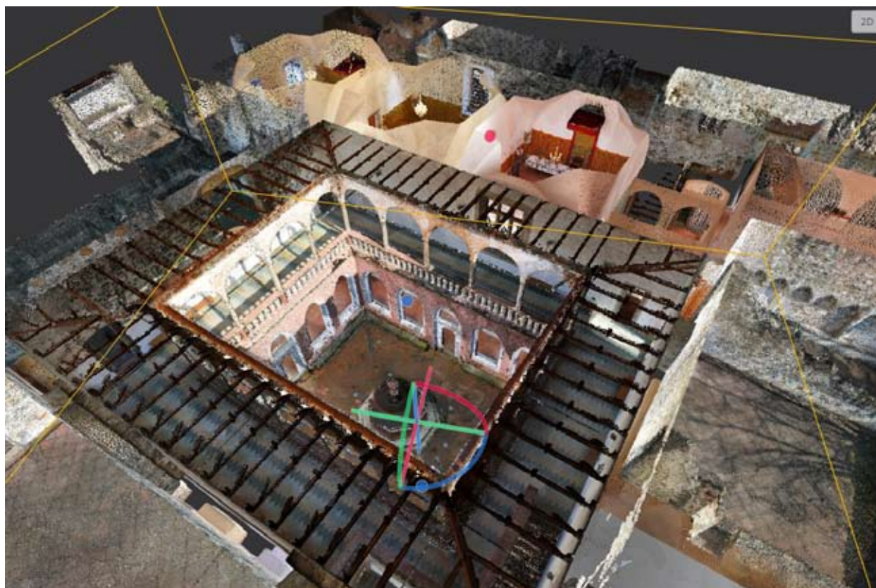
1. kép A Királyi Palota pontfelhője a NavVis alkalmazásban
