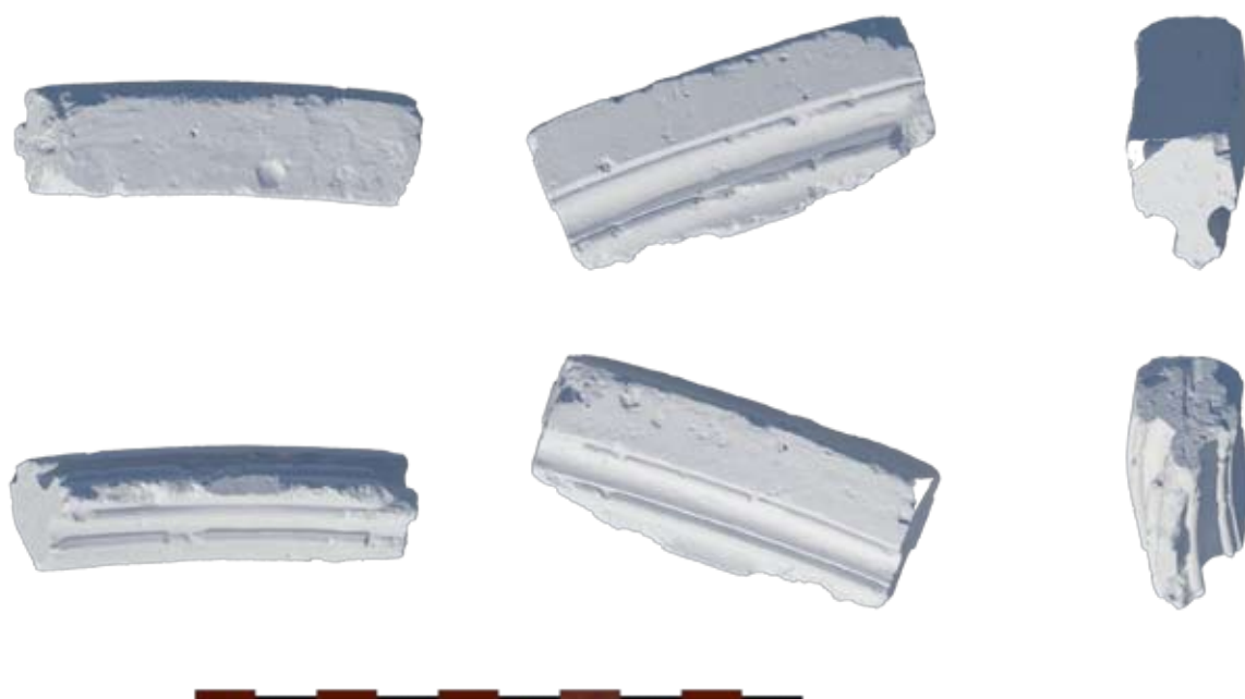
59. A szentélyboltozat alaprajzi vetületben is görbült vonalú boltozati bordája (Szőke Balázs – Mensor3D)
