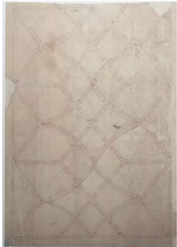
72. Boltozat alaprajza (19.962v) a bécsi Stephanskirche építőpáholyának gyűjteményéből (BÖKER 2005 nyomán)
