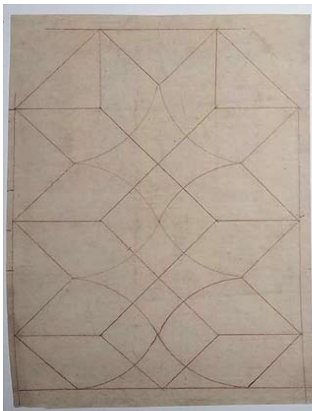
67. Szentélyboltozat alaprajza (17.013v) a bécsi Stephanskirche építőpáholyának gyűjteményéből (BÖKER 2005 nyomán)
